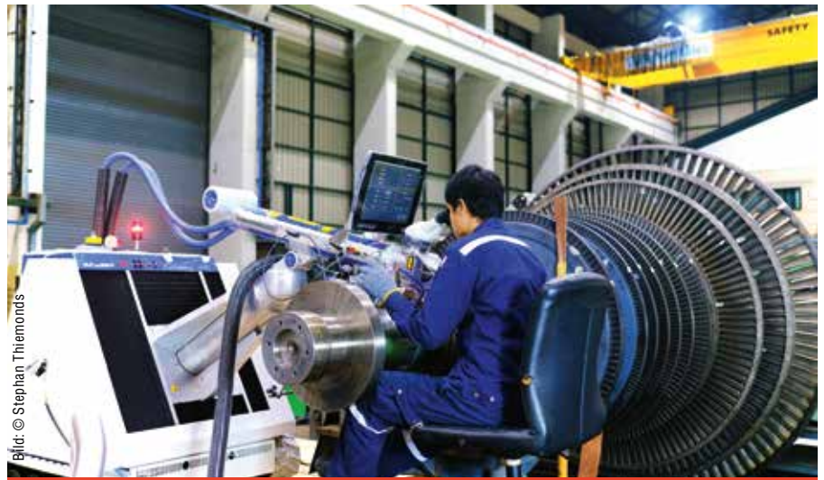
Bei der Reparatur von gerissenen Schweißnähten am Rotor eines Dünnschichtverdampfers setzten die Profis auf das Laserstrahl-schweißen.
